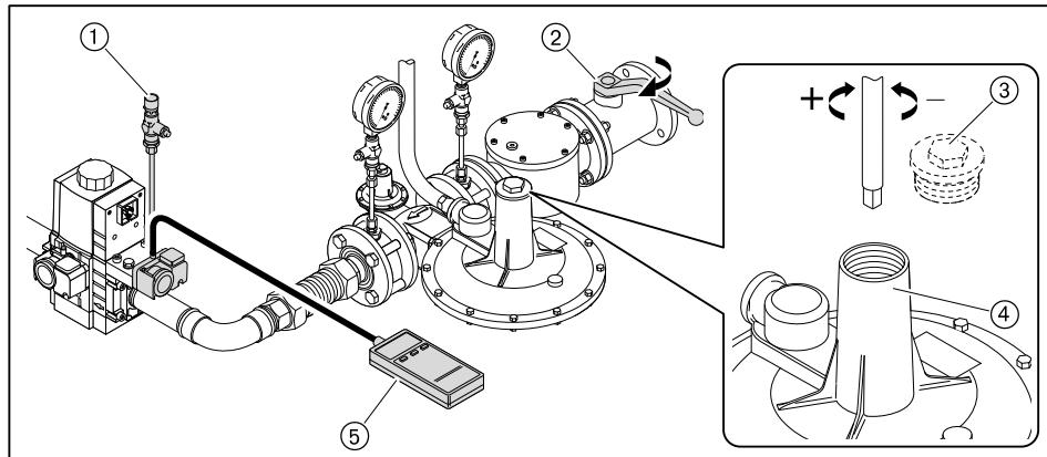
Предварительная настройка давления на регуляторе низкого давления
