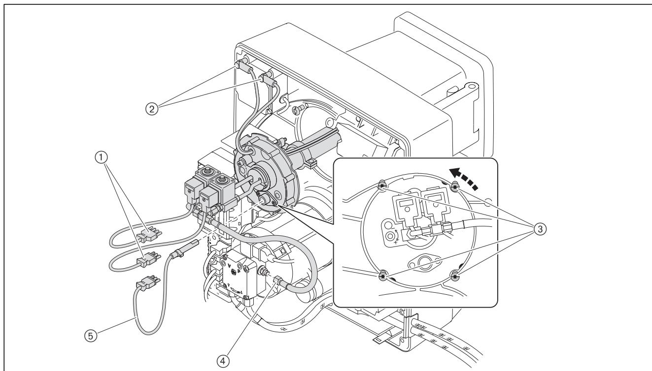
**9 Техническое обслуживание****9.7 Настройка смесительного устройства**
