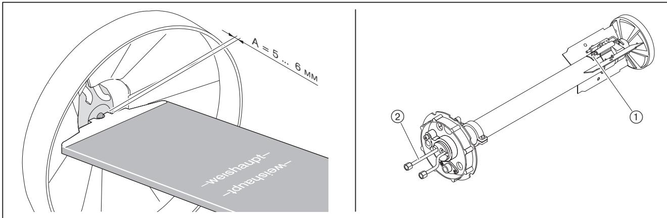
**Проверка базовой настройки**
