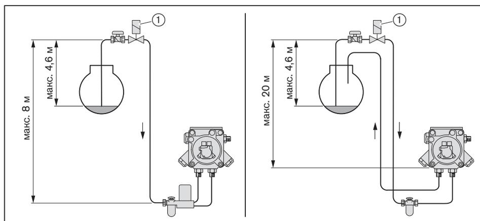
**12 Проектирование****12.1.1 Однотрубная система**
