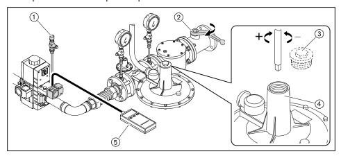
Предварительная настройка давления для регулятора низкого давления
