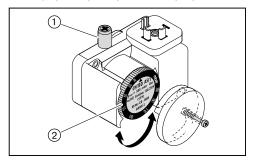
Настройка реле давления газа контроля герметичности
