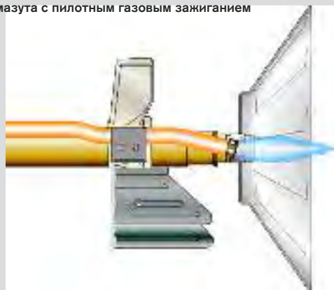
Зажигание мазута с пилотным газовым зажиганием
