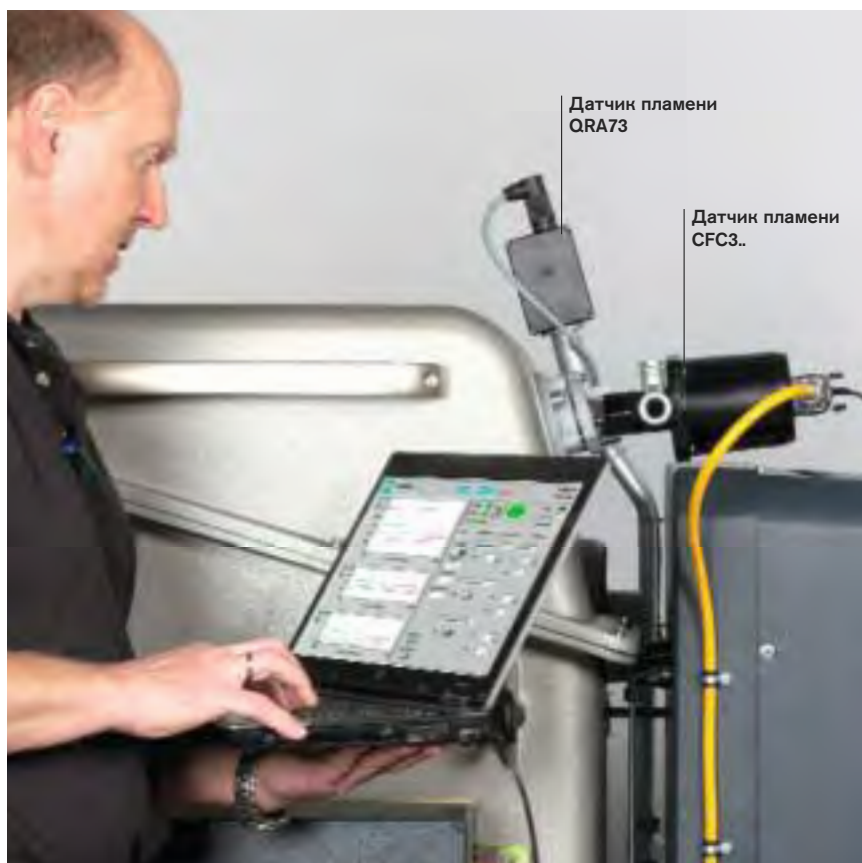
Проверка и оптимизация с помощью компьютерной программы
