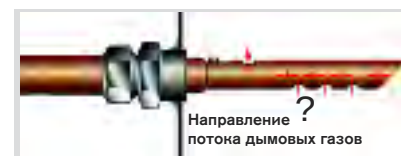
Устройство для забора пробы дымовых газов
