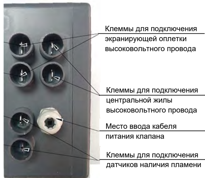
Рисунок 4.3.2 Инфраконтроль IC 3502. Подключение кабелей
