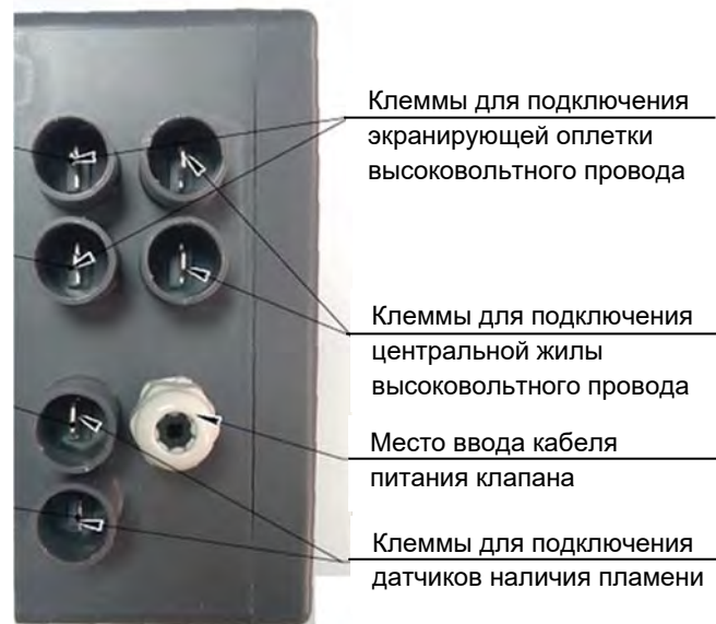
Рисунок 4.3.2 Инфраконтроль IC 3502. Подключение кабелей
