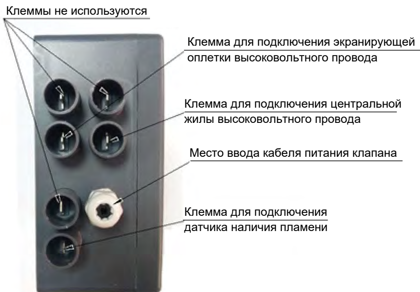
Рисунок 4.3.3 Инфраконтроль IC 3501. Подключение кабелей
