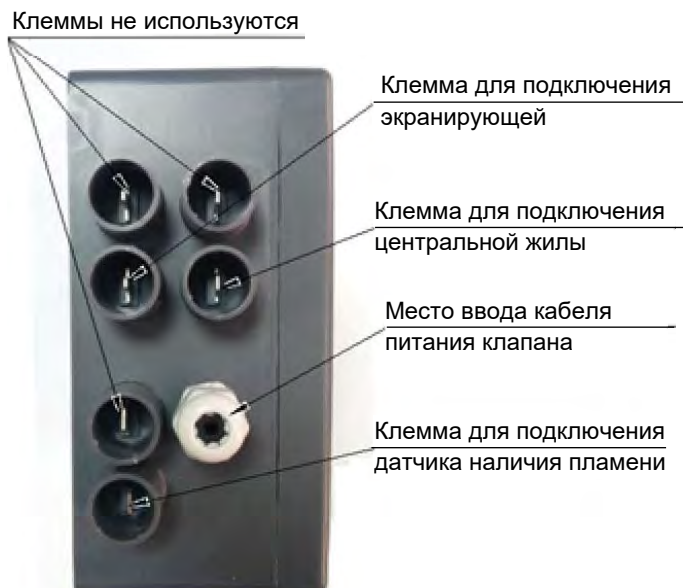
Рисунок 4.3.2 Инфраконтроль IC 3501. Подключение кабелей
