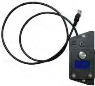
KIT E-BCU tool diagnostico (non incluso)
