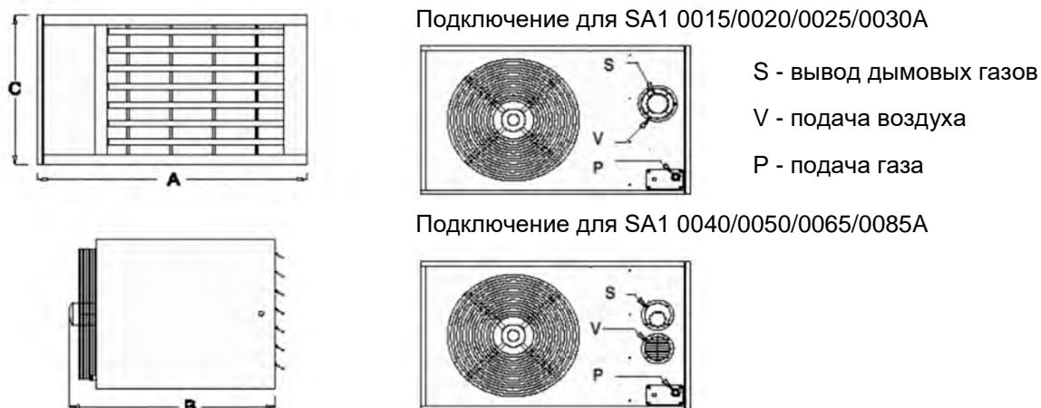
Рисунок 3.1.2 Внешний вид воздухонагревателя SA1 A.
