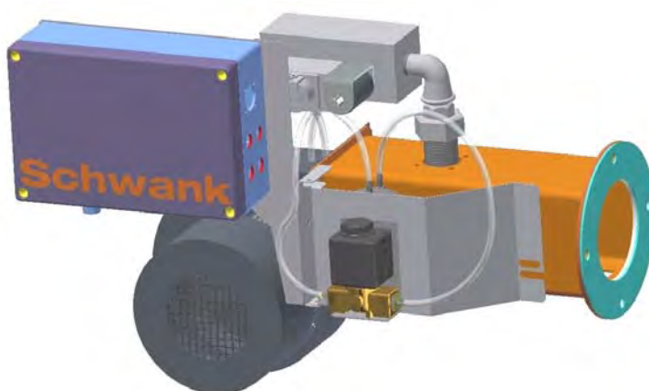
Рисунок 6.4.5 Вид блока горелки после полного переоборудования
