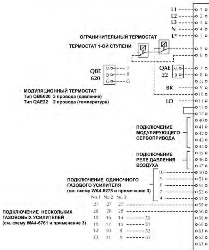
ПАНЕЛЬ УПРАВЛЕНИЯ СМОНТИРОВАНА НА ГОРЕЛКЕ
