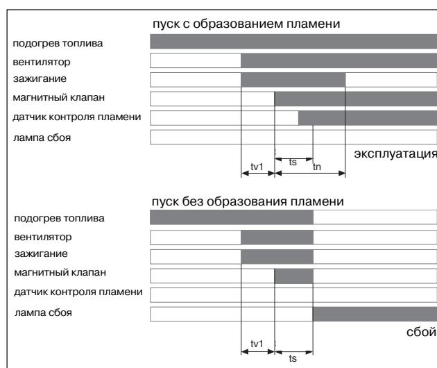
$ts$  - контрольно-предохранительный период
