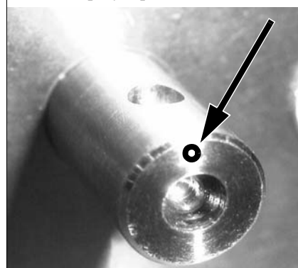
Монтаж регулировочного вала
